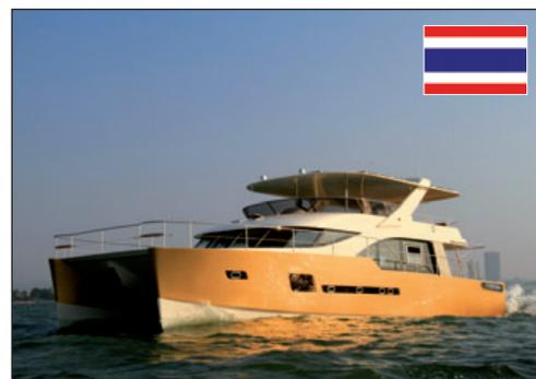
En décembre dernier, le chantier Bakri Cono basé en Thaïlande a mis à l'eau son Heliotrope 65', un catamaran à moteur que son propriétaire voulait totalement autonome au niveau de sa consommation électrique pour tous les éléments de confort à bord, y compris la clim, les machines à laver, les systèmes audio et vidéo, Internet, etc. Le bateau est ainsi équipé de plus de 7 kW de panneaux solaires...
